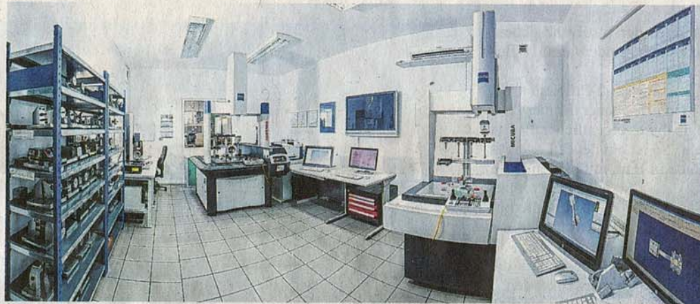
Klimatisierter Messraum mit modernster Zeiss-CNC-Messtechnik
